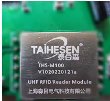
图3 内置自研核心 RFID 模块
